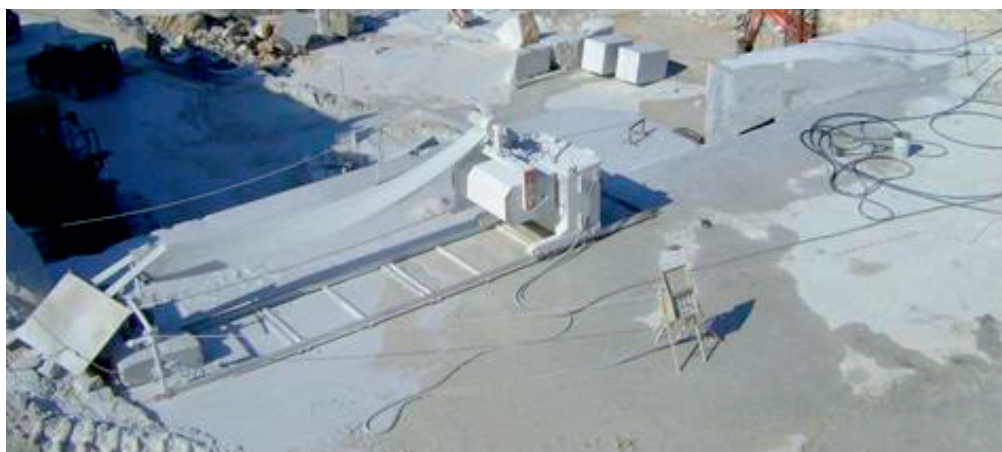
Foto 2 - rappresentativa della macchina tagliatrice a filo diamantato sovrastante la bancata franata che effettuava il taglio "a schiena"
