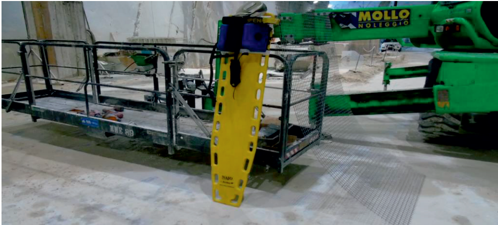
Foto 2 - fotografia rappresentativa del luogo di lavoro dopo l'incidente con la presenza della rete metallica che l'operatore non è riuscito a sollevare
