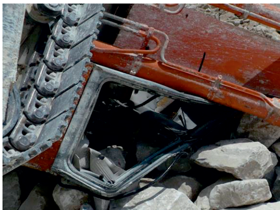
Foto 2 - particolare della cabina di guida parzialmente schiacciata.
