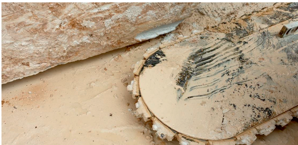
Foto 3 - particolare del segno di scivolamento rinvenuto sulla sommità della lama della tagliatrice, proprio in prossimità del punto di presunto contatto tra scarpone, bancata e denti della tagliatrice.
