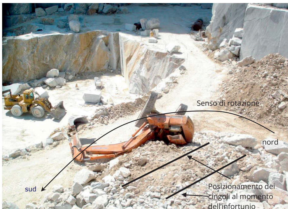
Foto 3 - presunta posizione e movimento dell'escavatore prima del ribaltamento
