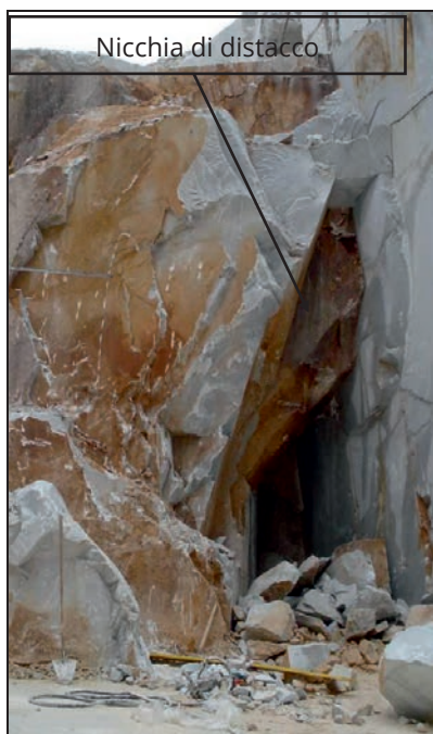
Foto 5 - "nicchia" dopo il distacco
