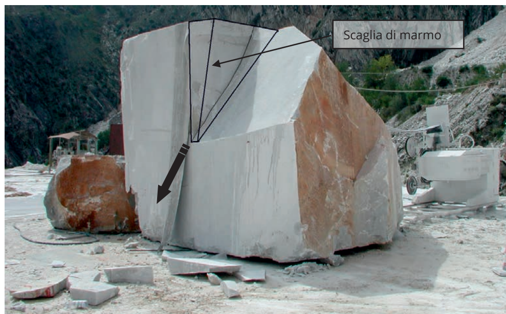
Foto 6 - ricostruzione grafica della scaglia di marmo rimasta in loco
