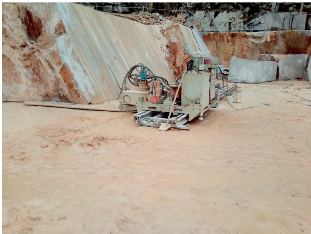
Foto 1 - vista della macchina tagliatrice a catena "da piazza" in cantiere a cielo aperto
