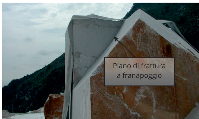
Foto 5 - fotografia rappresentativa del piano di frattura
