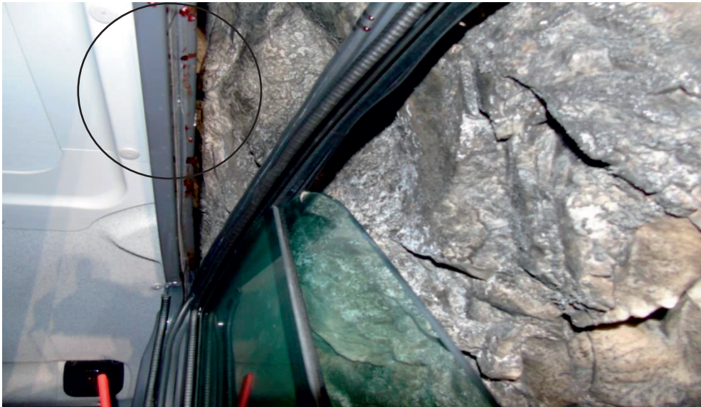
Foto 2 - particolare del punto in cui la mano dell'operatore è andata ad urtare contro la parete della galleria
